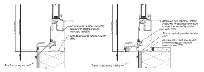
WINDOW INSTALLATION USING NAILING FINS AT POSITION 1
